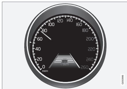
Linee laterali della funzione LDW.
