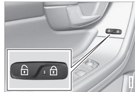
Pulsante della chiusura centralizzata
