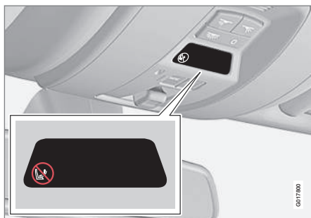
Indicazione dell'airbag lato passeggero attivato.
