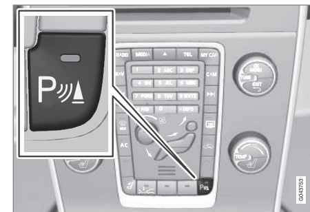
ON/OFF per Assistenza al parcheggio.
