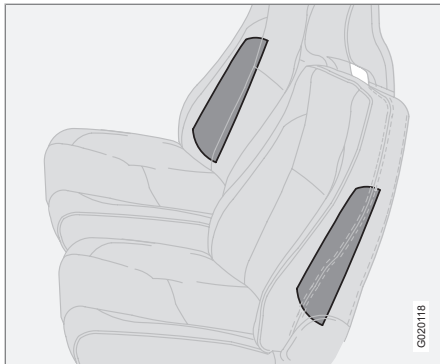
Colocación de airbags laterales.
