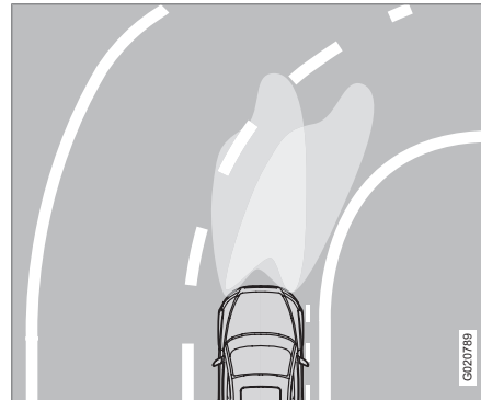
Haz luminoso con la función desconectada (izquierda) y conectada (derecha).
