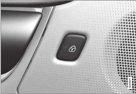
Låsknapp med indikeringslampa i baddörr.
