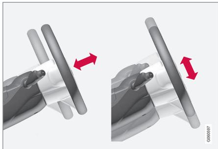
Le volant peut être réglé en profondeur et en hauteur.
