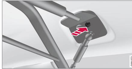
Montez la vis fournie et serrez à l'aide de la clé fournie de 6 mm. Répétez la procédure de l'autre côté. Couple de serrage recommandé : 20 Nm (15 pied-livre).
