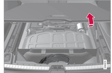
Le câble de charge se trouve dans l'espace de rangement situé sous le plancher du compartiment à bagages.
