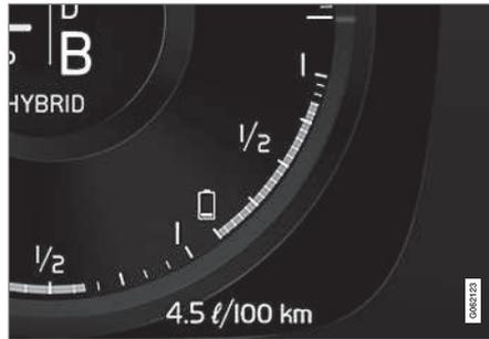
L'énergie de la batterie hybride est utilisée pour le moteur électrique, mais également pour refroidir ou réchauffer la voiture. L'ordinateur de bord calcule un kilométrage approximatif pour la quantité d'énergie disponible dans la batterie hybride.
