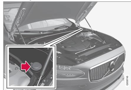
L'appoint en liquide lave-glace se fait dans le réservoir à bouchon bleu. Le réservoir est utilisé pour le lave-glace de pare-brise et lunette arrière ainsi que pour les lave-phares\*
