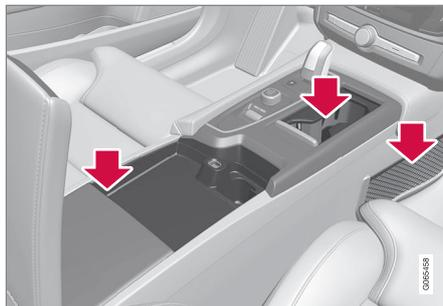
Compartiments de rangement avec porte-gobelets, prise électrique, filet de rangement\* et port USB dans la console tunnel.
