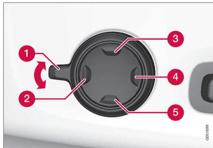
1. Activez la commande multifonctions en tournant la commande **1** vers le haut/vers le bas. La vue de réglage de siège s'affiche sur l'écran central.
