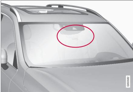
La zone indiquée doit être nettoyée régulièrement et ne doit pas être couverte (ni autocollant, ni filtre solaire, ni aucun autre objet, etc.).
