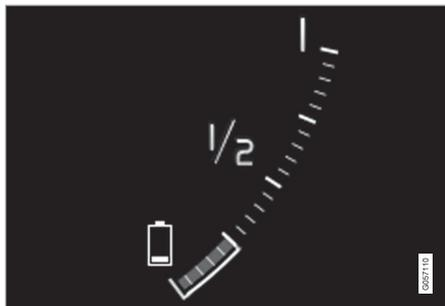
1. Si le niveau de charge est élevé, utilisez la voiture jusqu'à garder les 25 % restants. Si le niveau de charge est faible, chargez la batterie jusqu'à atteindre env. 25 %.
