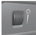
La molette du tableau de bord, à gauche du volant, permet de régler l'intensité lumineuse de l'écran, l'éclairage des commandes et l'éclairage d'ambiance\*
