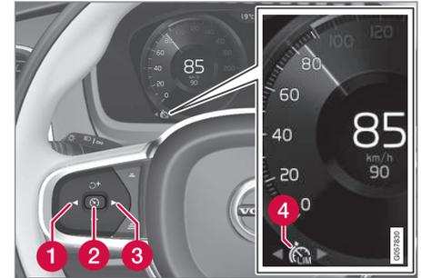
Le limiteur de vitesse n'est activé qu'au démarrage du moteur. Le réglage minimal de la vitesse maximale est 30 km/h (20 mph).
