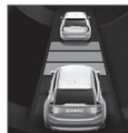
Ce n'est que lorsque le symbole de distance affiche deux véhicules que la distance temporelle avec le véhicule qui précède est ajustée par l'ACC.
