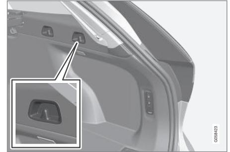
Les panneaux latéraux comportent également deux crochets pour sacs à provisions (un de chaque côté du compartiment à bagages).
