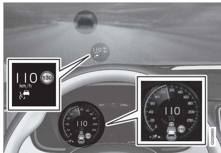
L'illustration précédente indique que le régulateur adaptatif de vitesse est réglé pour maintenir une vitesse de 110 km/h (68 mph) et qu'il suit un véhicule qui roule à la même vitesse.
