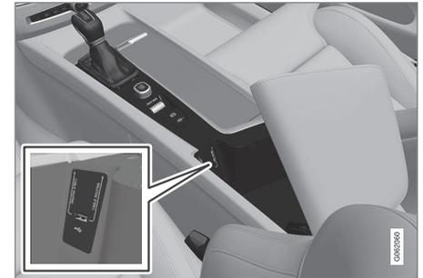
Prises USB (type A) de la console de tunnel. Vérifiez que le câble est en avant afin de ne pas le coincer en fermant la trappe.
