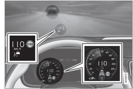
L'illustration précédente indique que Pilot Assist est réglé pour maintenir une vitesse de 110 km/h (68 mph) et qu'il suit un véhicule qui roule à la même vitesse.
