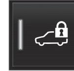
Le bouton de verrouillage privé se trouve dans la vue Fonctions de l'écran central. Selon l'état actuel du verrouillage, **Verr. voiturier déverrouillé** ou **Verrouillage voit. verrouillé** apparaît.
