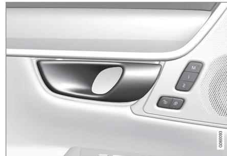
Poignée d'ouverture pour le déverrouillage alternatif d'une porte latérale<sup>12</sup>.
