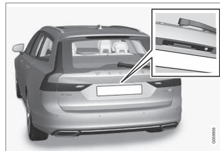
Le hayon est maintenu verrouillé par une serrure électrique.
