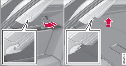
1. Saisissez la poignée et tirez le cache-bagages pour le passer au-dessus des panneaux latéraux du compartiment à bagages. Tirez jusqu'au bout.
