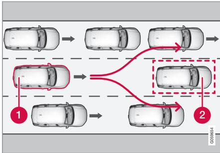
Le véhicule (1) ne "voit" aucune possibilité d'éviter le véhicule qui précède (2) et freine automatiquement par anticipation.
