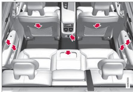
Compartiment de rangement dans le panneau de porte, porte-gobelets\* dans le dossier de la place centrale, compartiment de rangement\* sur le dossier du siège avant, prise électrique dans la console tunnel.
