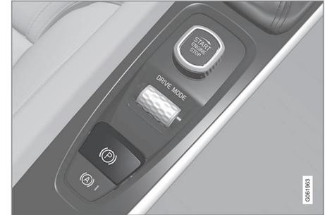
La commande de frein de stationnement se trouve sur la console de tunnel, entre les sièges.
