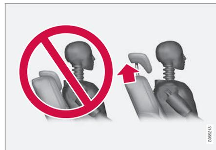
L'appui-tête de la place centrale doit être ajusté selon la taille du passager de manière à couvrir l'ensemble de la partie arrière de la tête. Réglez l'appui-tête manuellement selon vos besoins.
