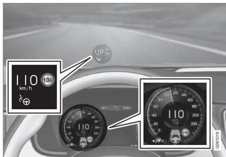
L'illustration précédente indique que Pilot Assist est réglé pour maintenir une vitesse de 110 km/h (68 mph) et qu'il n'y a aucun véhicule à suivre.
