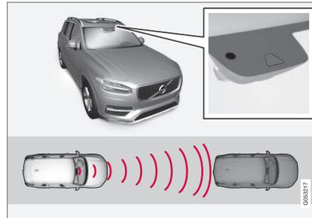
L'unité de caméra/radar mesure la distance au véhicule qui précède.
