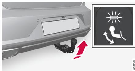
> Le crochet d'attelage sort mais n'est pas verrouillé. Le témoin clignote en orange. Le crochet d'attelage est prêt à être mis en position verrouillée.
