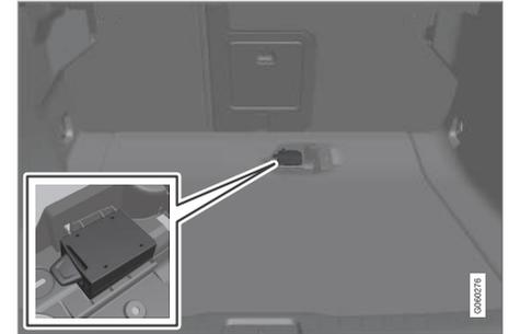
Placez une carte SIM dans le support situé sur le plancher du compartiment à bagages.
