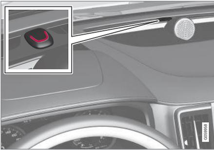
Une diode lumineuse rouge du tableau de bord clignote une fois toutes les deux secondes lorsque la voiture est verrouillée et lorsque l'alarme est activée.
