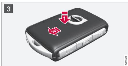
**3** Après utilisation, replacez la lame de clé à sa place dans la télécommande.
