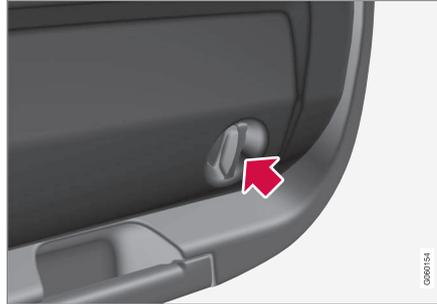
1. Détachez le panneau à l'intérieur du hayon en tournant d'abord les deux molettes d'un quart de tour dans le sens antihoraire puis en décrochant le panneau. Mettez le panneau de côté.
