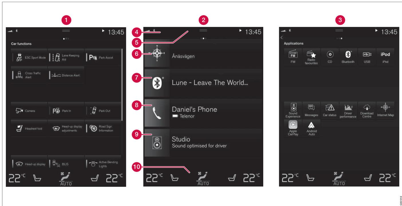
Trois des vues élémentaires de l'écran central. Balayer à droite ou à gauche permet d'accéder respectivement à la vue Fonctions et à la vue Applications<sup>5</sup>.
