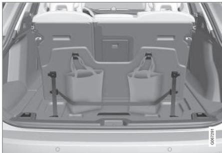
Deux crochets pour sacs à provisions et une sangle élastique<sup>3</sup> sont fixés sur le couvercle (partie de la trappe de plancher) dans le compartiment à bagages. La sangle peut être installée selon quatre positions différentes.
