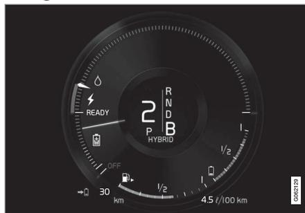
La voiture génère un courant et charge la batterie, lors par ex. d'une faible pression sur la pédale de frein ou lors d'un frein moteur en descente.
