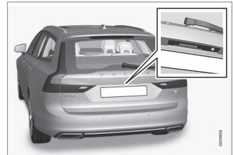
Le bouton gainé de caoutchouc sur le hayon ne peut servir qu'au déverrouillage.
