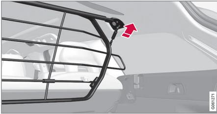
Placez les fixations de la grille de protection dans les fixations au plafond.
