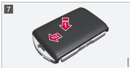
7 **1** ▶ Remplacez la face arrière de la coque et l'enfoncer jusqu'à entendre un clic.
