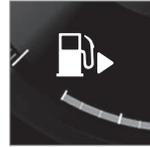
La flèche qui accompagne le symbole de réservoir sur l'écran conducteur indique le côté où se trouve la trappe du réservoir de carburant.
