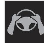
Si Pilot Assist détecte que le conducteur n'a pas les mains sur le volant, il est invité par un symbole et un message texte à reprendre activement le contrôle de la voiture.
