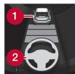
Ce n'est que lorsque le symbole de distance représente un véhicule (1) au-dessus du symbole en forme de volant que la distance temporelle au véhicule qui précède est réglée par Pilot Assist.
