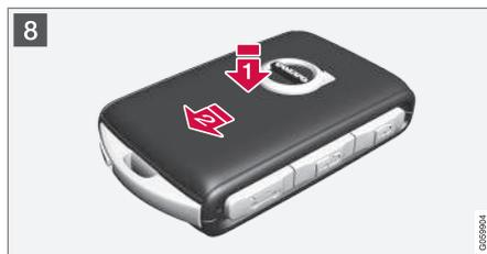
8 **1** ▶ Retournez la télécommande et remplacez la coque avant en l'enfonçant jusqu'à entendre un clic.
