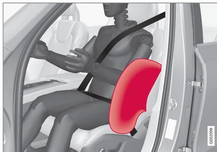
Les coussins gonflables latéraux sont montés dans les cadres extérieurs des dossiers des sièges avant et aident à protéger le conducteur et le passager des sièges avant.
