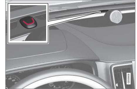
Une diode rouge sur le tableau de bord indique l'état du système d'alarme :
