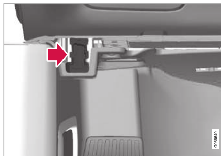
Diagnosekontakten (On-board Diagnostic-kontakten, OBDII) under instrumentpanelet i førersiden.
