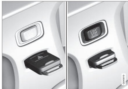
Startläs med fjärrnyckel utdragen/intryckt.
