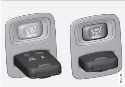
Uzaktan kumanda anahtarlı kontak anahtarı çıkarıldı/takıldı.
