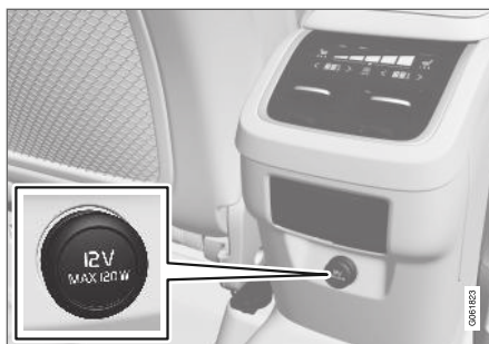
12 V-stikkontakt i tunnelkonsol, bagsæde.
