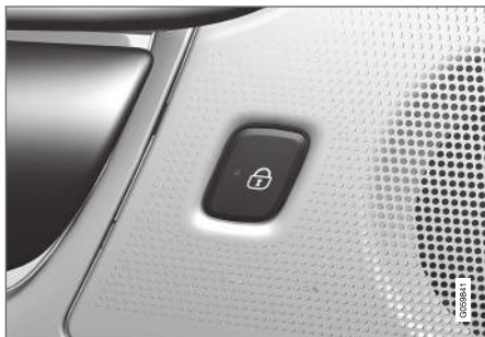
Låseknop med indikeringslampe i bagdør.
