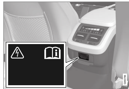
Stikkontakt i tunnelkonsol, bagsæde.
