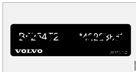
④ Mærkat med motorkode og motorens løbenummer.
