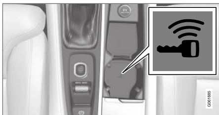
Backup-læserens placering i tunnelkonsollen.
