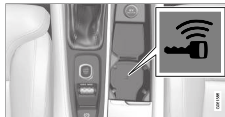
Backup-læserens placering i tunnelkonsollen.
