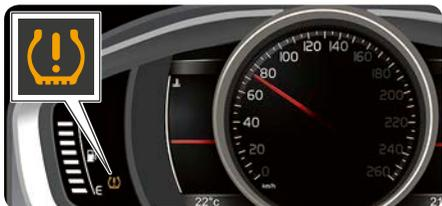
更換輪胎或改變胎壓後，務必進行校正。燈光照明時，**(i)** 系統需要校正。依據下列步驟進行：
