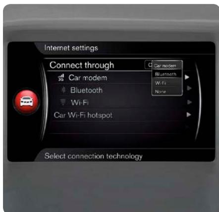
1 透過 Bluetooth® 連接手機或啟用手機中的 Wi-Fi 連線分享功能。若要使用車載數據機連線，請將 SIM 卡裝入手套箱內的讀卡機中。
