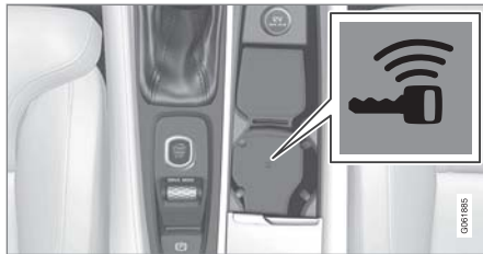
備用讀取器位於中央扶手控制台中。
