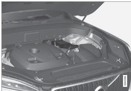
支援電瓶位於支撐桿旁的電瓶箱中。
