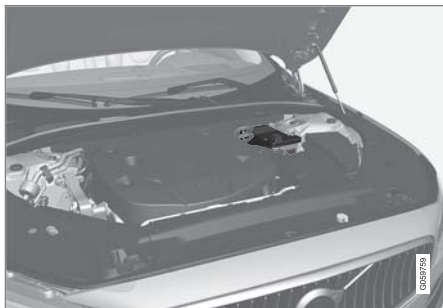
支援電瓶位於支撐桿旁的電瓶箱中。
