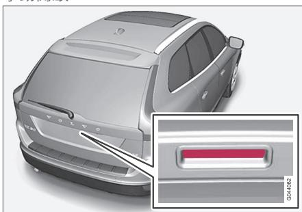
含電氣接觸點的橡膠板。
