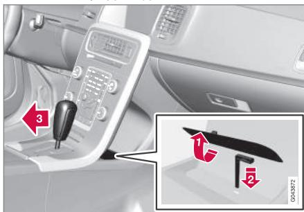
如果汽車由於電瓶沒電等狀況而無法行駛，則排檔桿必須自 P 檐切換至其他檔位才能移動汽車。
