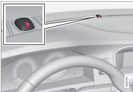
儀錶板上有紅色的 LED 指示燈指示警報系統狀態：
