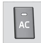
當 AC 按鍵內的指示燈亮起時，表示系統的自動功能正在控制空調。
