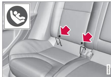
ISOFIX 安裝系統的固定點隱藏於後座外側座椅椅背下方。
