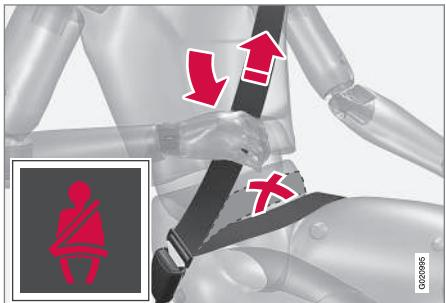
將安全帶的對角線肩帶朝肩膀方向拉以拉緊大腿上方的腰帶。腰帶應盡可能放在較低的位置（不要靠在腹部上方）。
