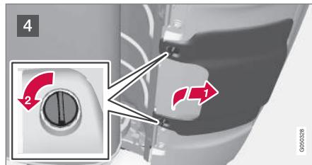
4 將蓋子的鉤子勾到保險桿後緣內以重新安裝保護蓋。將蓋子向上推，直到螺栓進入正確位置 。最後，將螺栓轉四分之一圈 ，將蓋子接上。在組裝時將螺栓把手轉成橫的很重要。
