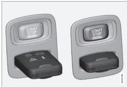
遙控器已自點火開關拔出/已插入點火開關內，且 START/STOP ENGINE 按鍵。
