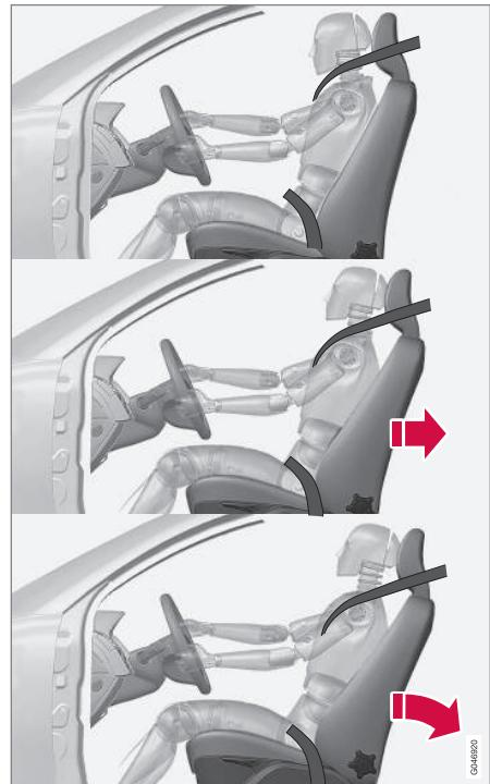
頸椎撞擊防護系統 (WHIPS) 會在遭受後端撞擊時啟動，而撞擊角度、撞擊速度及相撞車輛的性質都會對此造成影響。
