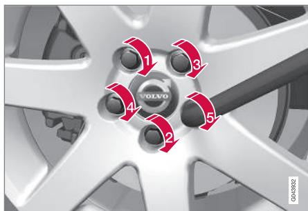
4. 以對角方向鎖緊車輪螺栓。正確鎖緊車輪螺栓是非常重要的。鎖緊至扭矩 140 Nm。請以扭力扳手檢查扭力。
