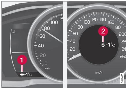
① 車外溫度計專用顯示幕，數位儀錶板
