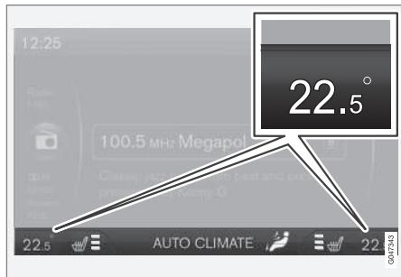
中控台的顯示螢幕中會顯示每一側目前的溫度。
