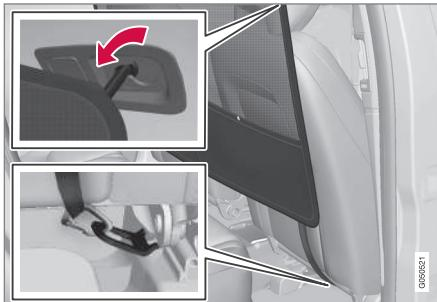
注意，要確定您在把座椅/椅背再次推回的時候，不要推得太猛，使得座椅/椅背壓緊安全網 - 只要調整到座椅/椅背剛剛碰到安全網就可。
