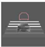
有五種不同時間間隔可以選擇，在綜合儀錶板上顯示為1 - 5條水平線，線條越多其時間間隔越長。一條線相當於與前車相距1秒，5條線相當於3秒。
