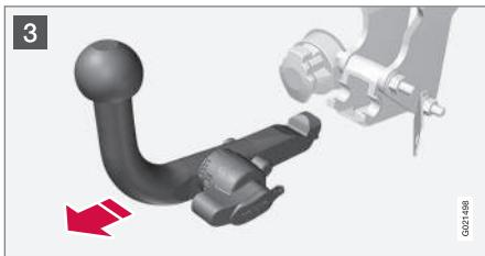
3 將鎖定輪一直向下轉動，直到停止位置。將拖車鉤向後及向上拉出時，將鎖定輪固定在該位置。
