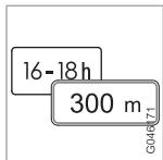
部分速度僅在經過特定距離後或一天內的特定時間才適用。系統會在顯示速度的符號下顯示專供額外標誌使用的符號讓駕駛人注意該狀況。
