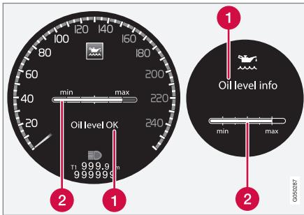
顯示幕中的訊息與圖表。左側顯示器顯示於數位綜合儀錶板中，右側顯示器為類比式。
