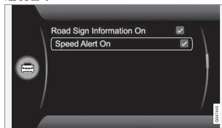
駕駛人可選擇在車速比相關速限多時速 5 公里 (5 mph)以上時接到警示。當超過相關最大速度時，系統會用閃爍符號顯示該
