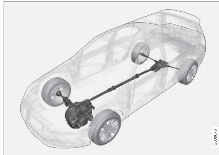
全時四輪驅動 (All Wheel Drive) 表示汽車同時驅動全部四個車輪。
