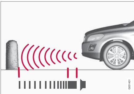
車輛後方偵測距離約為 0.8 公尺。表示前面有障礙物的音響訊號來自前方其中一個揚聲器。
