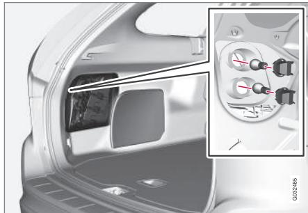
煞車燈和倒車燈燈泡都要從行李廂內更換。
