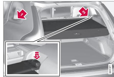
將行李廂上蓋拉到行李上方，並鉤住行李廂後柱的凹孔。
