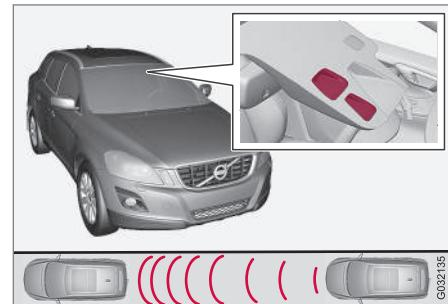
雷射感知器發射器與接受器的視窗 12。
