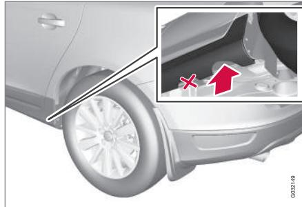
檢查確定千斤頂如前圖所示牢固定位於錨座，且支撐腳垂直定位在錨座的下方。
