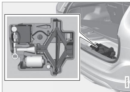
行李廂地板下方有汽車的拖鉤環、千斤頂\*與車輪扳手\*。此處還有可鎖式車輪螺栓套筒和塑膠車輪螺帽工具的存放空間。
