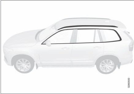
Części, które należy myć detergentem o wartości pH mieszczącej się w zakresie od 3,5 do 11,5.
