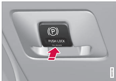
Ручка стояночного тормоза – тормоз задействован.
