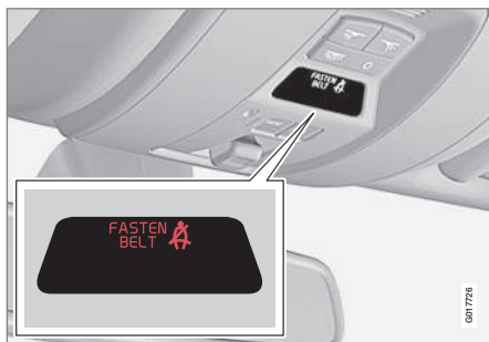
Témoin de rappel de la ceinture de sécurité dans la console de plafond
