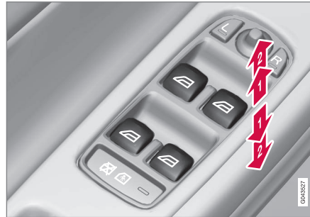
Fonctionnement des vitres électriques
