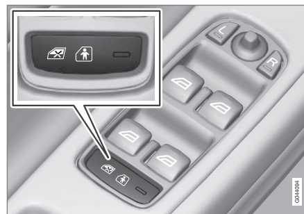
Pannello di comando nella portiera del conducente.
