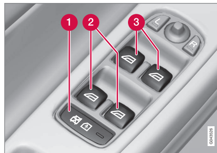
Pannello di comando nella portiera del conducente.
