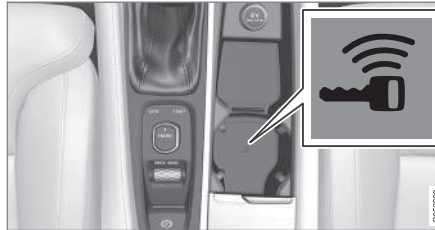
Lage des Schlüssellesegeräts in der Tunnelkonsole.
