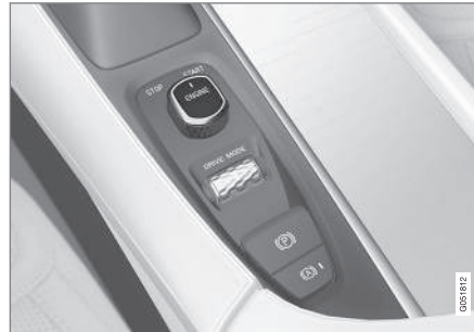
Startschalter auf der Tunnelkonsole.
