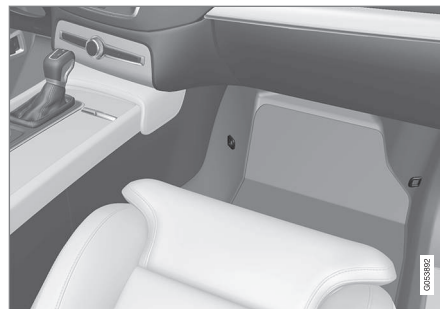
Lage der Befestigungspunkte für den Vordersitz
