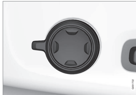
Seitlich am Sitzpolster angebrachter Multifunktionswechsler.
