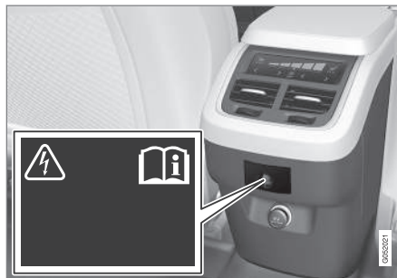
230-V-Steckdose in der Tunnelkonsole, zweite Sitzreihe.
