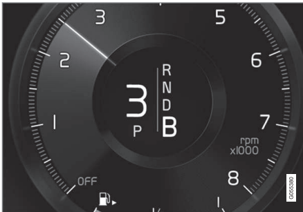
Schaltstellung B auf dem Fahrerdisplay.
