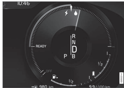
Fahrerdisplay bei Antriebsmodus Hybrid (Elektro- und Verbrennungsmotor).
