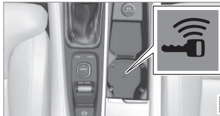
Lage des Schlüssellesegeräts in der Tunnelkonsole.
