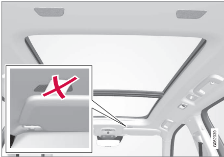
Mikrofone im Dachhimmel.
