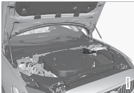
Η εφεδρική μπαταρία 12 V βρίσκεται στον χώρο του κινητήρα.
