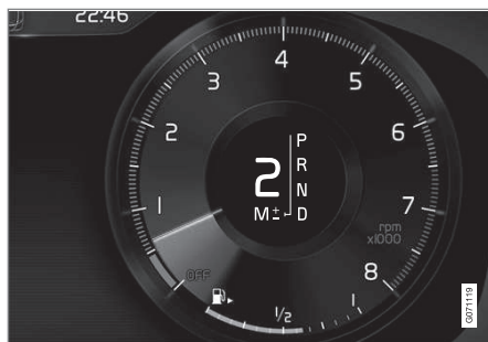
Οθόνη του οδηγού κατά την αλλαγή σχέσης από τα χειριστήρια αλλαγής ταχυτήτων στο τιμόνι στη λειτουργία χειροκίνητης αλλαγής σχέσεων, μεγάλος επιλογέας ταχυτήτων.
