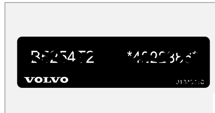
4 Dekal för motorkod och motorns tillverkningsnummer.
