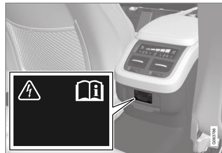
Eluttag i tunnelkonsol, baksäte.
