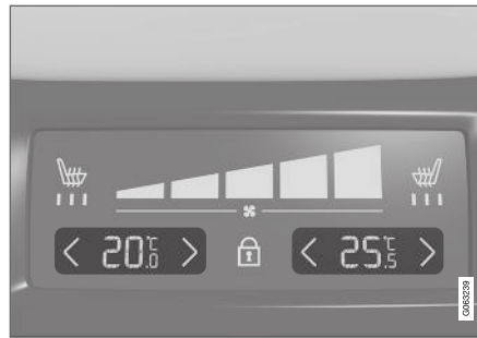
Temperaturreglage på klimatpanelen bak på tunnelkonsolen.
