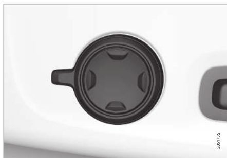
Multifunktionsreglaget, placerad på sidan av sätets sitt-del.
