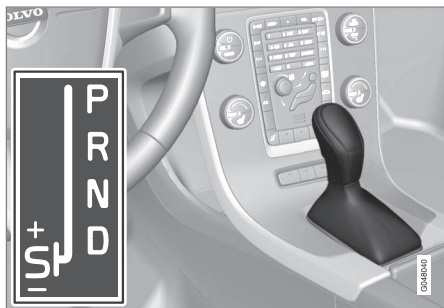
D: Posizioni del cambio automatico. +S- : Posizioni del cambio manuale. S: Modalità Sport*.
