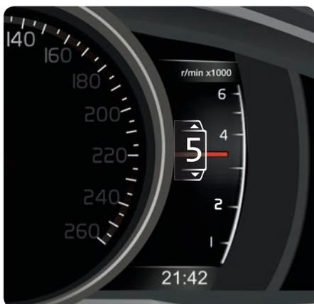
ギヤシフトインジケーターの矢印は、最適燃費の実現のために、シフトアップまたはシフトダウンに適したタイミングを表示します。
