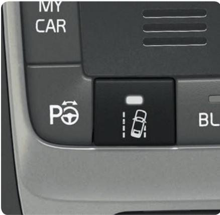
車両がサイドラインを超えそうな場合、LKAがステアリングホイールに軽いトルクを与えて車両を車線内に維持しようとします。車両がサイドラインを超えると、LKAがステアリングホイールを振動させて警告を發します。
