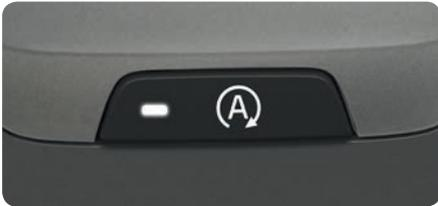
ボタンのランプとコンパインド・メーター・パネルのシンボルが点灯し、機能が作動していることを示します。
