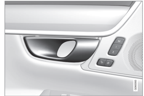
Openingsgreep voor alternatieve ontgrendeling op zijportier 10 .
