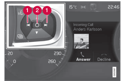
Meldung auf dem Fahrerdisplay 5 und rechtes Lenkradtastenfeld.
