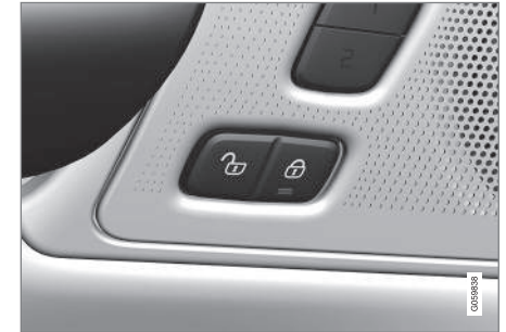
Ver- und Entriegelungstaste mit Anzeigeleuchte an der Vordertür.
