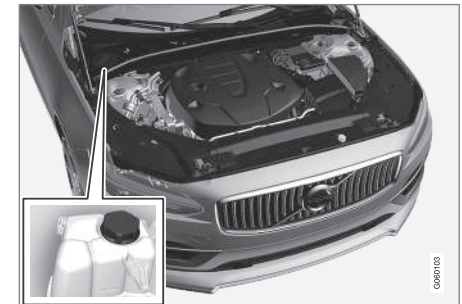
Ausgleichsbehälter der Kühlanlage, Linkslenker.
