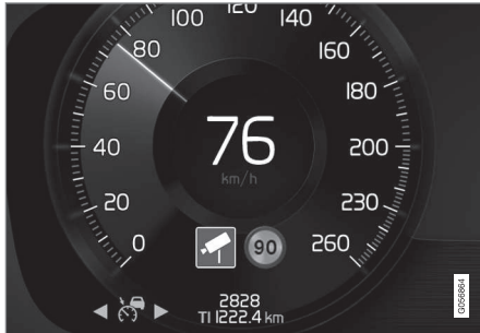
Radarkamera-Warnung im Fahrerdisplay.
