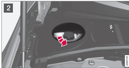
Ausgleichsbehälter der Kühlanlage, Rechtslenker.
