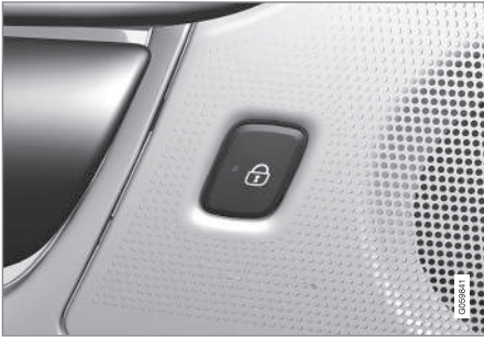
Verriegelungstaste mit Anzeigeleuchte an der Fondtür.
