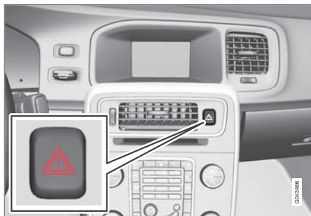
非常点滅灯ボタン
