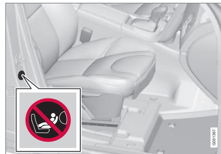
2. alternatíva: légzsákcímke az utas oldali ajtószlopon. A légzsák címkéje akkor válik láthatóvá, amikor ki van nyitva az utasajtó.
