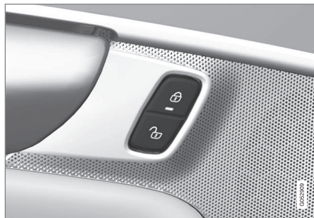
Boutons de verrouillage et témoins lumineux de porte avant
