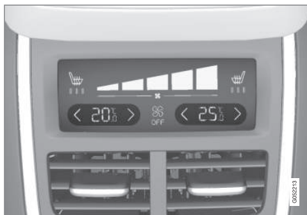
Commandes de température sur le panneau de climatisation de la face arrière de console de tunnel.
