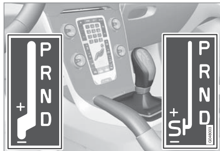
D: オートマチックギヤポジション。+/-: マニュアルギヤポジション。S: スポーツモード*。 3
