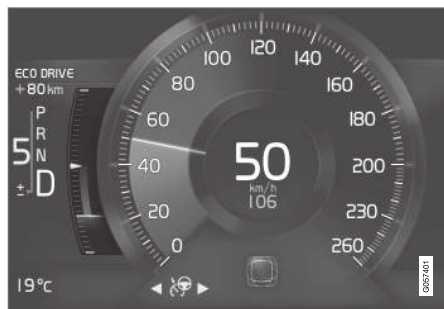
Указатель ЕСО на 8-дюймовом дисплее водителя.
