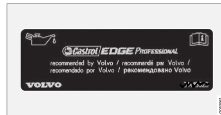
6 Наклейка с указанием масла для двигателя.
