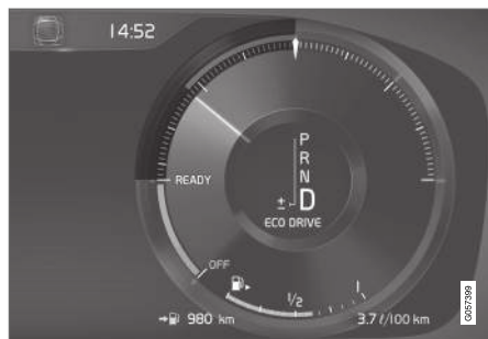
Указатель ЕСО на 12-дюймовом дисплее водителя*.
