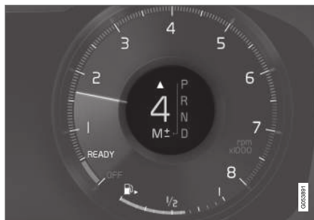
Индикатор переключения передач на 12-дюймовом дисплее водителя*.
