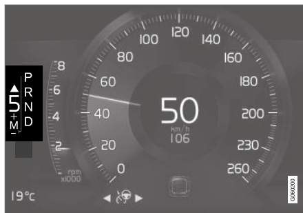
Индикатор переключения передач на 8-дюймовом дисплее водителя.
