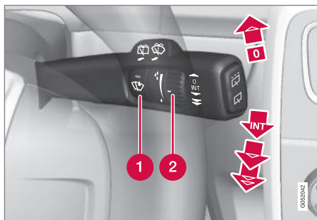
Stěrače čelního okna a ostříkovače čelního okna.
