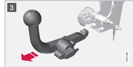
3 บิดปุ่มล็อกลงสุดจนหยุด จับไว้ในตำแหน่งนั้นในขณะที่ดึงส่วนลูกปืนข้อต่อไปข้างหลังและดึงขึ้น
