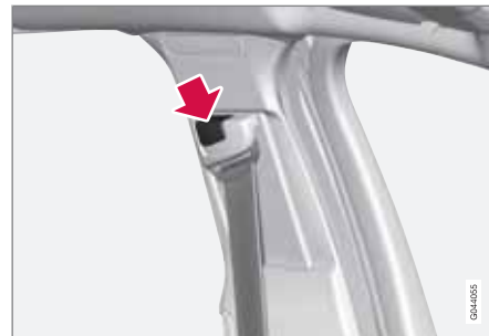
Hoogteverstelling van de gordelgeleider. Druk de knop in en zet de gordelgeleider hoger of lager. Zet de gordelgeleider zo hoog mogelijk zonder dat de gordel daarbij langs de nek schuurt.
