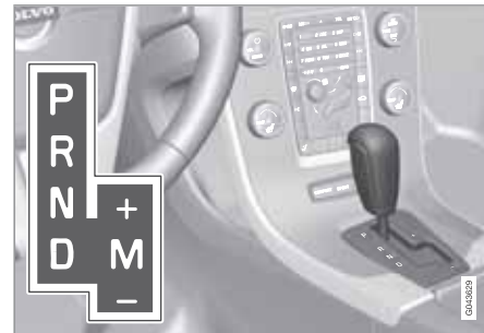
D: automatisch schakelen. M (+/-): handmatig schakelen.
