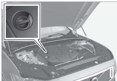
フィラーパイプ 1314
