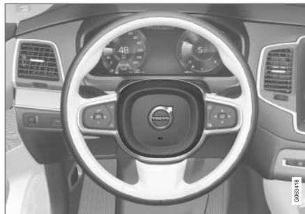
Signalhornet är placerat på rattens centrum.
