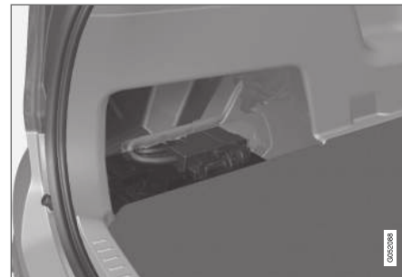
Startbatteriet är placerat i lastutrymmet.
