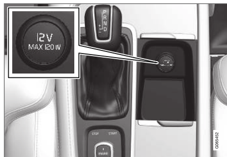
12 V-eluttag i tunnelkonsol, framsäte.
