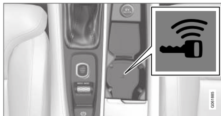
Backup-låsarens placering i mugghållaren.
