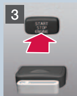
3. Nacisnąć krótko przycisk START/STOP ENGINE , aby uruchomić silnik.
