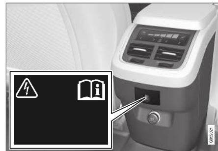
Eluttag i tunnelkonsol, andra sätesraden.
