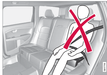
Virheellinen sijainti, pää ei saa olla niskasuojan yläpuolella eikä vyö saa mennä olkapään alapuolella.
