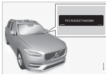
El VIN tiene una ubicación similar en todos los modelos.
