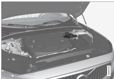
La batería de apoyo de 12 V está situada en una caja al lado del amortiguador vertical.
