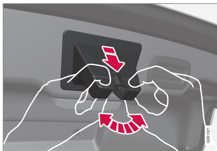
Cubierta de goma sobre el cierre de la tapa del maletero.
