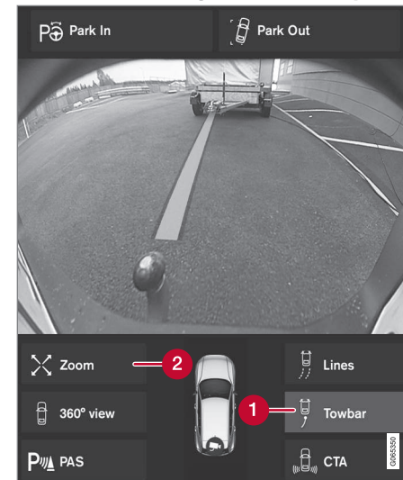
Enganche de remolque con línea auxiliar.
