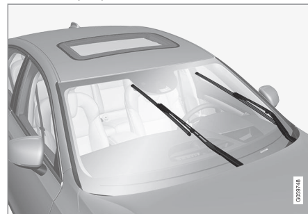
Escobillas de limpiaparabrisas en posición de servicio.
