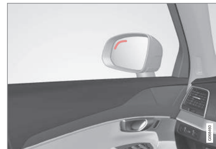
Ubicación del testigo de BLIS.
