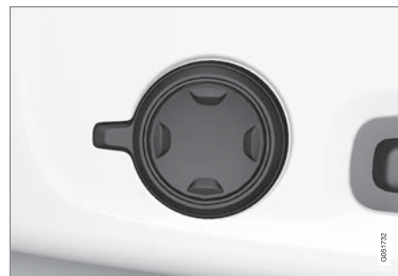
多功能控制器，位於座椅的座部側面。
