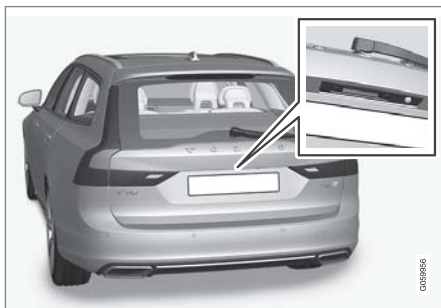
尾門上的橡膠壓板只能用於開鎖。
