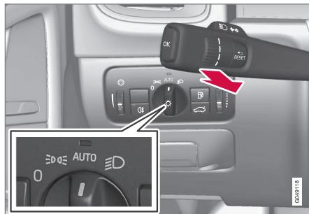
Stuurhendel en verlichtingsdraaiknop in stand AUTO .
