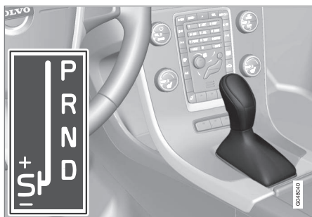
D: automatisch schakelen. +S- : handmatig schakelen. S: Sport-stand*.
