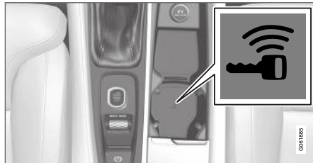
Emplacement du lecteur de secours dans la console tunnel.
