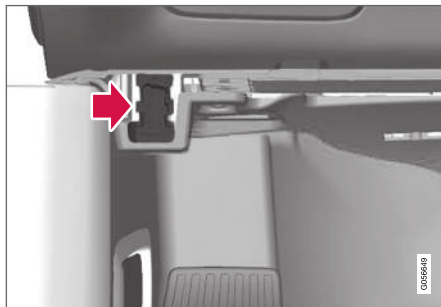
Prise de diagnostic (prise On-board Diagnostic, OBDII) sous le tableau de bord, du côté conducteur.
