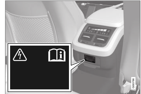
Sähköliitäntä tunnelikonsolissa, takaistuin.
