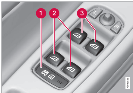
A vezetőajtó vezérlőpanelje.
