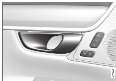
Maniglia per lo sbloccaggio alternativo nella portiera 21 .
