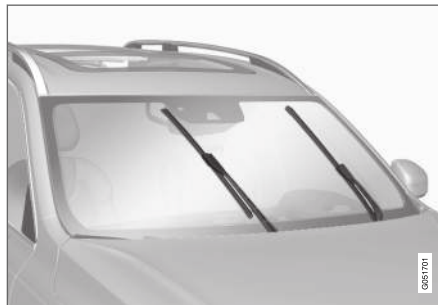
Spazzole tergicristallo in posizione di assistenza.
