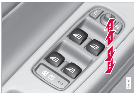
Fonctionnement des vitres électriques
