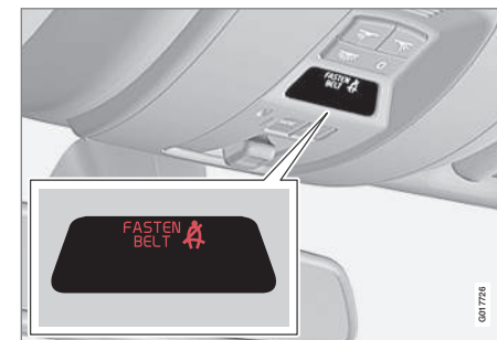
Témoin de rappel de la ceinture de sécurité dans la console de plafond
