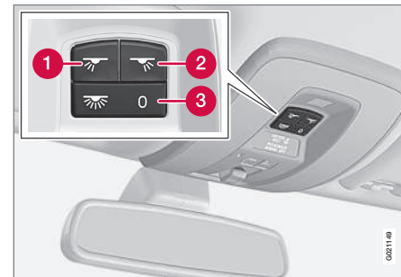
Interrupteurs d'éclairage, éclairage de pavillon avant
