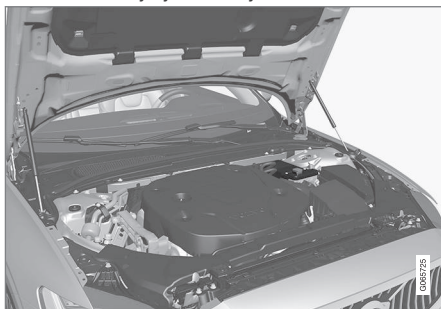
12 V varuaku asub mootoriruumis.
