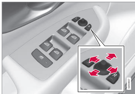
Mando de retrovisores exteriores.
