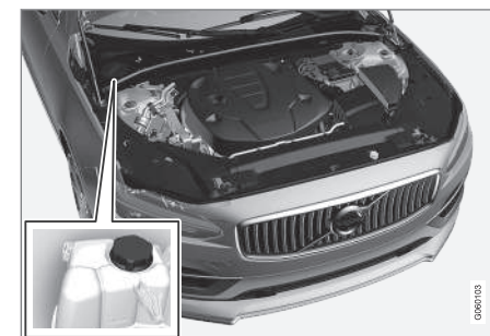
Depósito de expansión del sistema de refrigeración, vehículo con el volante a la izquierda.
