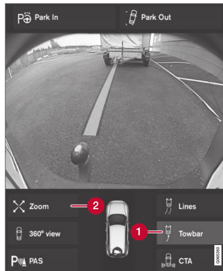
Vilkšanas iekārta ar novietošanas palīgliniju 123 .
