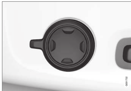
Daudzfunkcionālais vadības slēdis, atrodas sēdvietas sānos.
