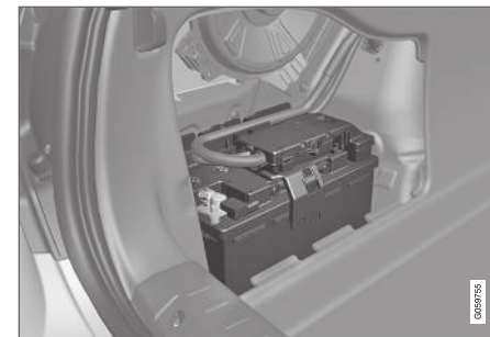
Startera akumulators atrodas bagāžas nodalījumā.
