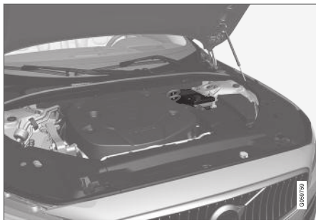
Atbalsta akumulators atrodas kastē blakus statnim.
