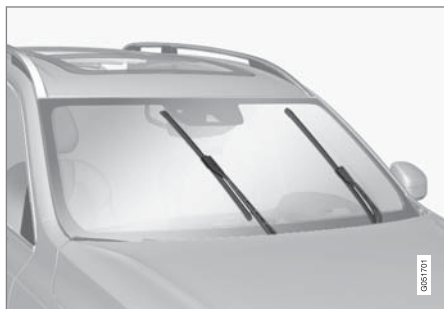
位於維修位置的雨刷片。
