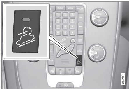
Włączanie/wyłączanie funkcji HDC.
