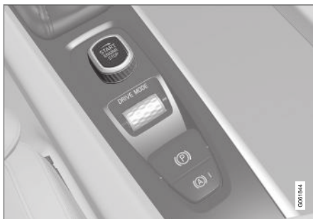
Startvredet i tunnelkonsolen.
